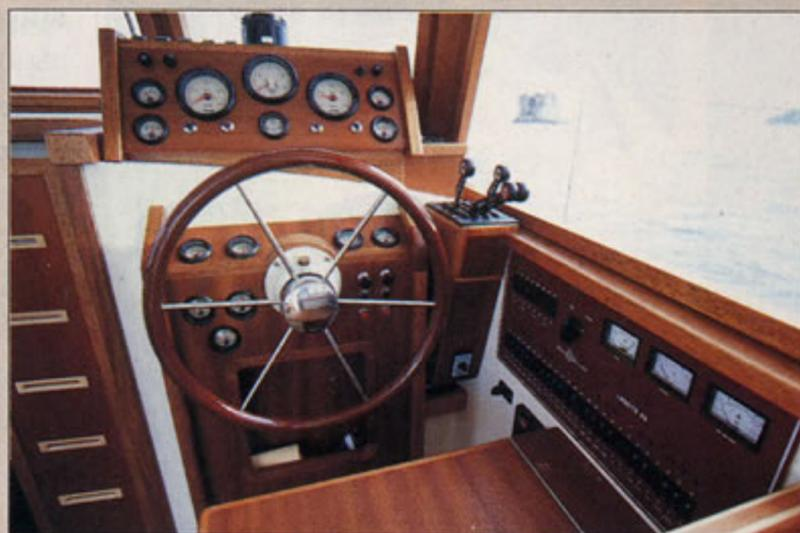
**Sopra, la stazione di guida e il quadro elettrico con le utenze protette da magnetotermici. A sinistra, alle spalle della timoneria, è sistemata la cucina a scomparsa.**
