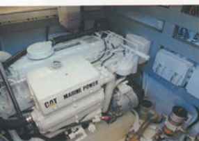
La sala motori ospita due entrobordo Caterpillar C7 da 420 cavalli.
